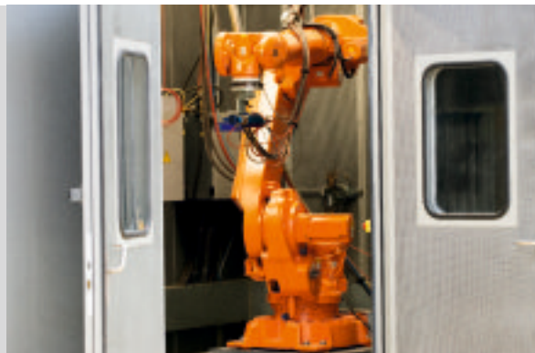
КОМПЛЕКС ПО НАНЕСЕНИЮ ГАЗОТЕРМИЧЕСКОГО ПОКРЫТИЯ (SULZER METCO)
